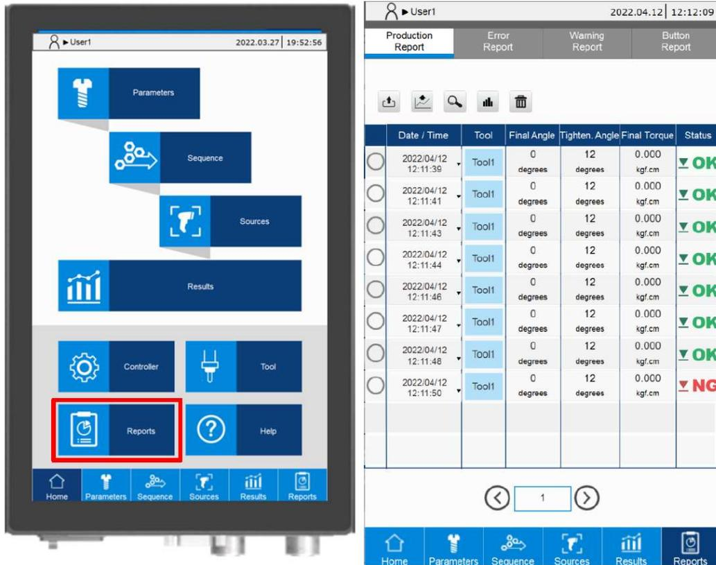
レポート記録の各行(エントリ)をクリックすると、締め付け結果の詳細と動作曲線グラフが表示されます。
