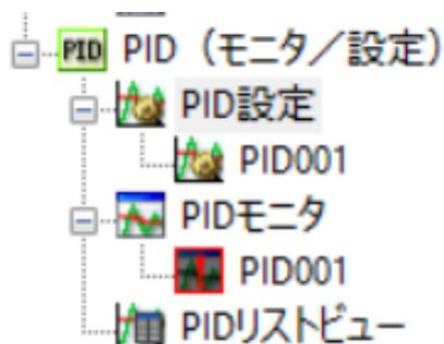
これは通常、PID ループが[PID 設定]で構成され、プロジェクトが PLC にダウンロードされたが、PID ループのパラメータが PLC レジスタに書き込まれていない場合に発生します。[PID 設定]を開き、「PLC へのレジスタ値書き込み」を選択します。PID モニタを開くと、PLC PID ループ値が PLC から読み込まれ、現在値列に表示されます。新しい値の列は、PC プロジェクトの値で埋められます。
